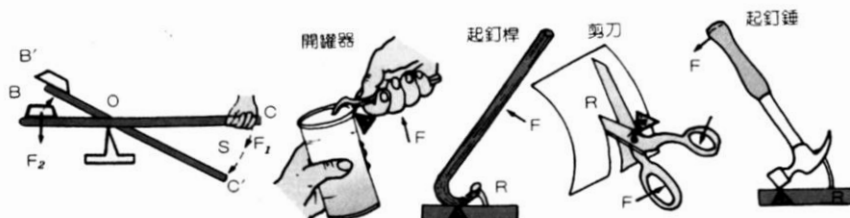
圖：轉軸在抗力點與施力點之間的槓桿，不一定省力。
